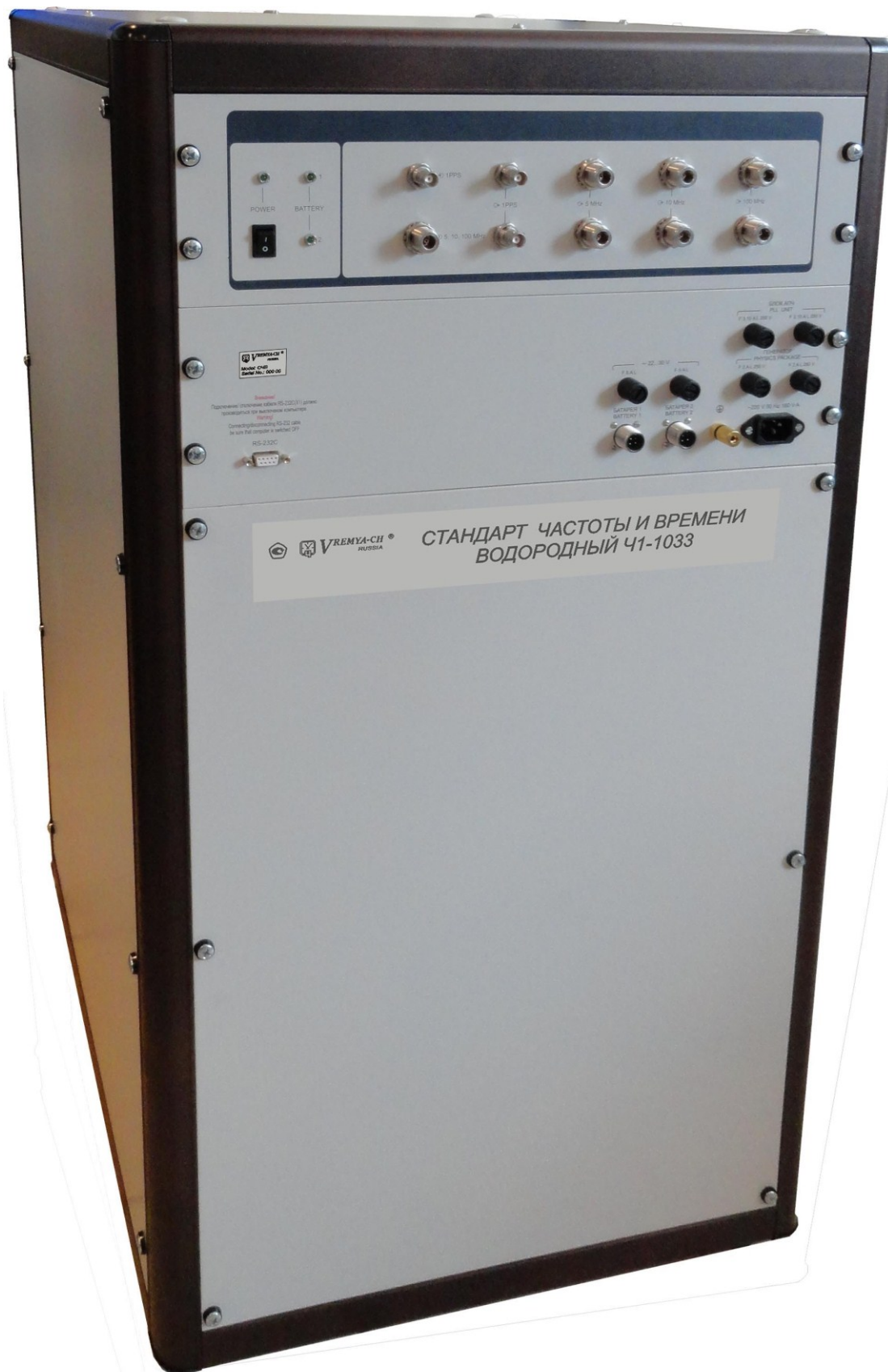
Рисунок 1 – Внешний вид стандарта частоты и времени водородного
