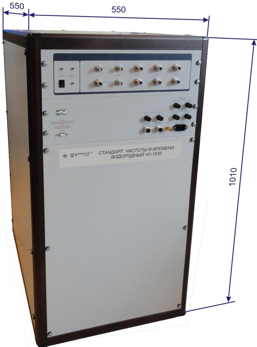
Рисунок А1. Габаритные размеры прибора
